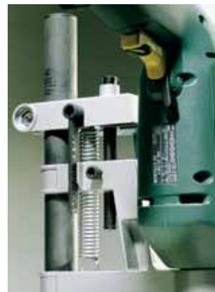
réglage de la profondeur de perçage par butée
