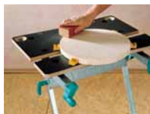
mors en plastique pour serrage à plat
