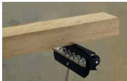
le support fixe sert à rallonger la surface d'appui d'un établi et à immobiliser les pièces longues
