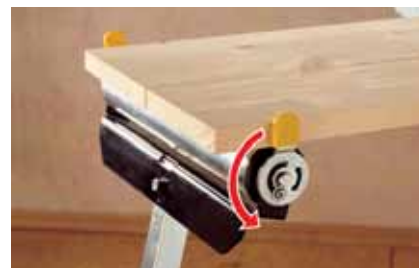
le support à rouleau permet d'orienter facilement les pièces dans le sens de l'usinage
