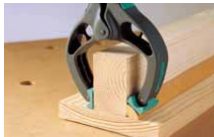
mâchoires mobiles s'adaptant à la pièce de travail
