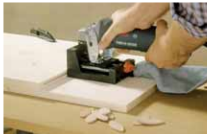
assemblage par chevilles plates
