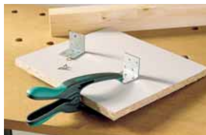
leur longueur importante permet de fixer dans des endroits plus éloignés des bords
