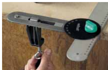
se fixe par vissage sur table ou établi
