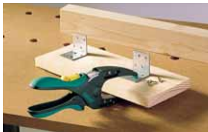
mâchoires de grande profondeur permettent de serrer loin du bord
