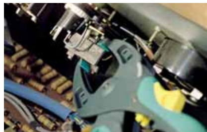
les bras de serrage longs et fins sont idéaux pour atteindre les endroits difficiles d'accès
